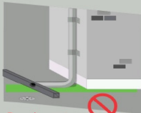
Branchement directement à la rue
